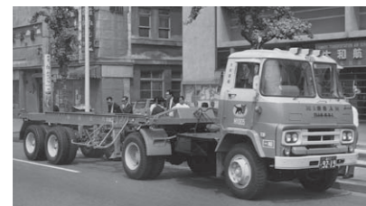
本社前で披露された国際規格の10トン海上コンテナ専用トラクター(1968年)
