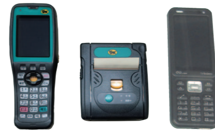
第7次 NEKO システムの端末 ポータブルPOS(PP、左)、プリンタ(中央)、 携帯電話(右)
