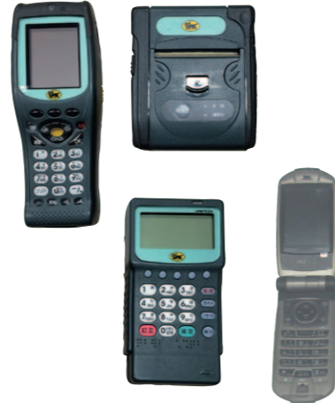
第6次 NEKO システムの端末 ポータブルPOS(PP、左上)、プリンタ(右上)、 決済用端末(ピンパッド、左下)、携帯電話(右下)
