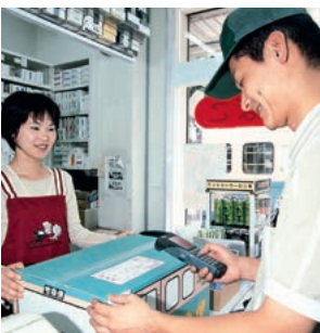
16 第 5 代 NEKO 系統的 PP，實現了透過雷射掃描器瞬間讀取條碼 (2001 年)
