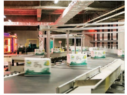
13 中部 Gateway 的交叉帶分揀機。透過滑動底部的分類方式，處理能力是過去的 2 倍
