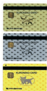
14 由上而下為第 4 代 NEKO 系統採用的三種「IC 卡」，分別是 SD 用、顧客用、經銷店用。在減輕過去非電子式經銷店與 SD 雙方的負擔方面，可說是劃時代的進步
