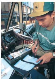
11 第3代 NEKO 系統的 PP 附屬的光筆，實現了在顧客處進行高精度地輸入資訊
