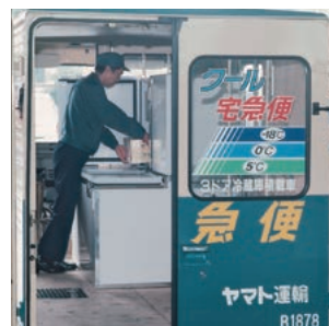
12 低溫宅急便開始當時在Walk-through車上搭載的3個溫度區車載冰箱
