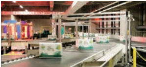
21 「中部ゲートウェイ」でのクロスベルトソーター。底面をスライドさせる仕分け方法で、従来の2倍の処理能力をもつ
