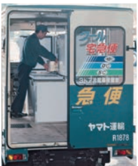
17 クール宅急便発売当時のウォークスルー車に搭載された3温度帯車載冷蔵庫
