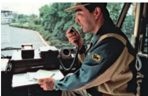
④集荷指令システムでは、MCA無線とコンピュータを連動させ、集配車両に搭載された端末機のプリンタで、集荷内容などの情報を打ち出すことが可能に
