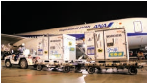
24 沖縄国際物流ハブで、航空保冷コンテナを貨物機に積み込む
