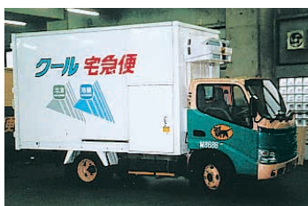
エコクール車 (クール対応型電気式MPバン) 2000年6月導入 さらに地球温暖化問題に適切に対応するために、エンジンを止めても冷凍・冷蔵庫内を冷却できる専用バッテリー搭載の電気式MPバンを共同開発。以後導入。
