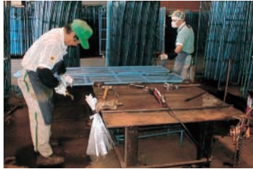
ロールボックスパレット(左2点)、コールドボックス(右)の修理。パーツごとに分解して、曲がりや歪みの修正、溶接、キャスター交換などを行う
