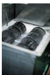
エアエレメントの洗浄処理
