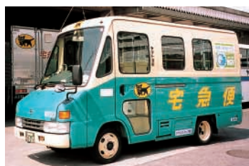
ヤマト仕様CNG車 (2tウォークスルー車) 2000年2月導入 バン型に続き、主力車種であるウォークスルー車でCNG車を共同開発。以後、インフラ整備された都市部を中心に導入。
