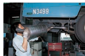
車両のセンターパイプに酸化触媒を装着
