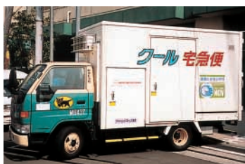
ヤマト仕様CNG車 (2tMPバン*) 1997年7月導入 地球温暖化の主因とされるCO2排出量の少ないCNG車をバン型車両で共同開発。以後、CNG燃料供給施設のある地域に導入。
