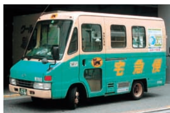
ヤマト仕様LPG車 (2tウォークスルー車*) 1995年3月導入 自動車メーカーとの共同開発による、ヤマト仕様低公害車第1号。以後、当社の低公害車の主力として都市部、住宅地を中心に順次導入。
