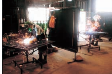
ロールボックスパレット(左2点)、コールドボックス(右)の修理。パーツごとに分解して、曲がりや歪みの修正、溶接、キャスター交換などを行う
