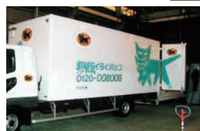
修理・塗装を終了し、再生したボデーを新しいシャーシに取り付け
