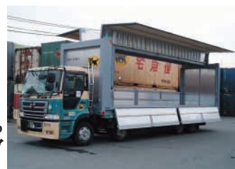
トラックと同じように脇が開くウイング式コンテナを開発
