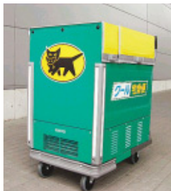
機械式クール台車。夜間退社時に充電すれば自動的に5時間保冷できます
