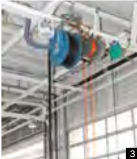
①ツインパワーリフト。後ろのリフトが車体の長さに応じて動くので、軽自動車から大型トラックまで作業が行えます ②ハイリフトホイールドローリー。フォークリフトと台車の機能を併せ持ち、車体を上げた状態でタイヤを取り外し、タイヤ周りの作業を楽な姿勢で行うことができます ③バキュームシステム。粉じんを吸引し、パイプを通して集積。空気を汚さず、粉じん処理（水で流して乾かす）の手間もかかりません
