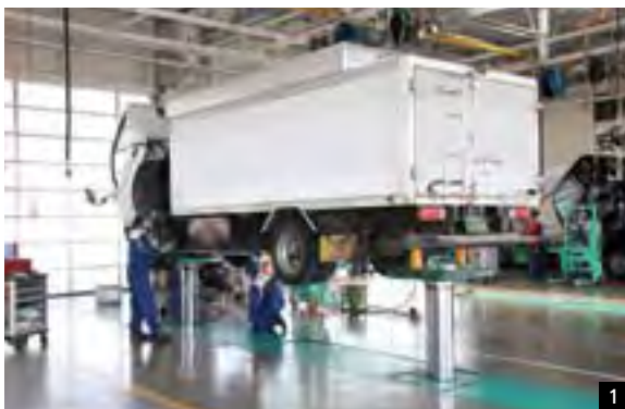
①ツインパワーリフト。後ろのリフトが車体の長さに応じて動くので、軽自動車から大型トラックまで作業が行えます ②ハイリフトホイールドローリー。フォークリフトと台車の機能を併せ持ち、車体を上げた状態でタイヤを取り外し、タイヤ周りの作業を楽な姿勢で行うことができます ③バキュームシステム。粉じんを吸引し、パイプを通して集積。空気を汚さず、粉じん処理（水で流して乾かす）の手間もかかりません
