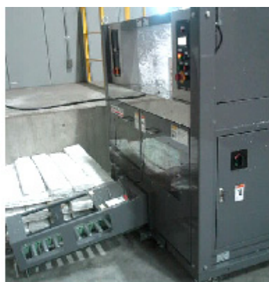
回収した発泡スチロールを 専用機で粉碎・圧縮
