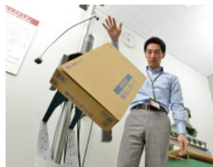
落下試験では、さまざまな角度で、包装資材を落下させ、衝撃の伝わり具合を測定。
