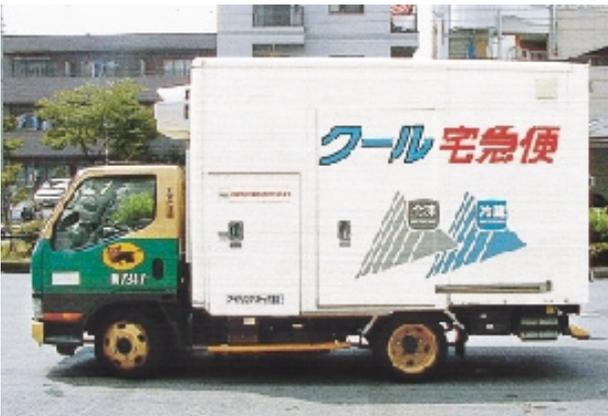
クール対応型電気式MPバン「エコクール車」(2000年6月)
