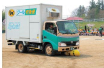
トラックの死角を学ぶ通称「ガリパトレーナー」。運転席から見える範囲をゴムひもで示しています。子どもたちは実際に運転席に座り、ゴムひもの下にいるお友だちが見えるかどうか体験します
