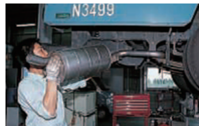
ディーゼル微粒子除去装置の取付作業(2004年)
