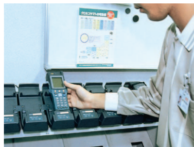
第5次 NEKO システムの新機能 上／レーザーキャナでバーコードを瞬時に読み取る PP 下／WS へのデータ転送を行う接続機器
