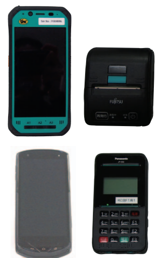
第8次 NEKO システムの端末 タブレット(左上)、プリンタ(右上)、 携帯電話(左下)、カード決済端末(右下)
