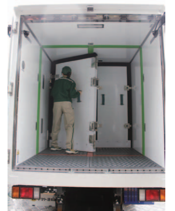
冷凍・冷蔵スペースが変更可能な新型車両
