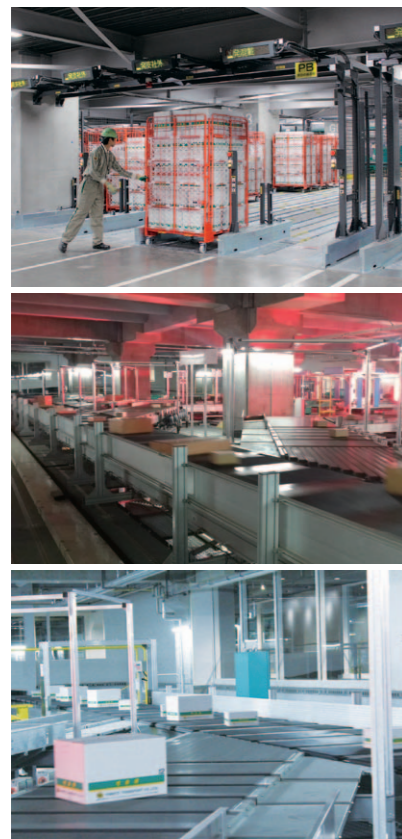
1、2階の宅急便仕分けエリア(上から、前詰め搬送機、クロスベルトソータ、荷物の合流地点)
