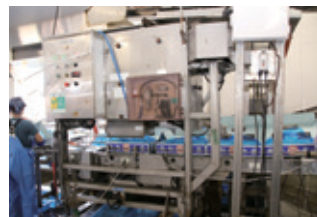
東和水産が導入した鮮魚定量縦並べ装置
