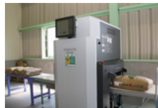
コンベアに載せるだけで1分間に30kgのお米約6袋を検査
