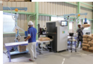
収穫されたお米は袋単位で一つひとつ全量検査されてから倉庫に保管される
