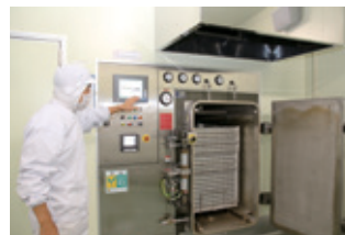
加熱、調理、殺菌、冷却までできる圧力容器（小野食品）
