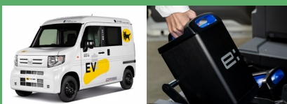
カートリッジ式バッテリーの軽EVを用いた集配業務実証
